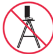
fig. 17 – sostare in piedi sul gradino superiore o sulla piattaforma solo se è presente il parapetto
