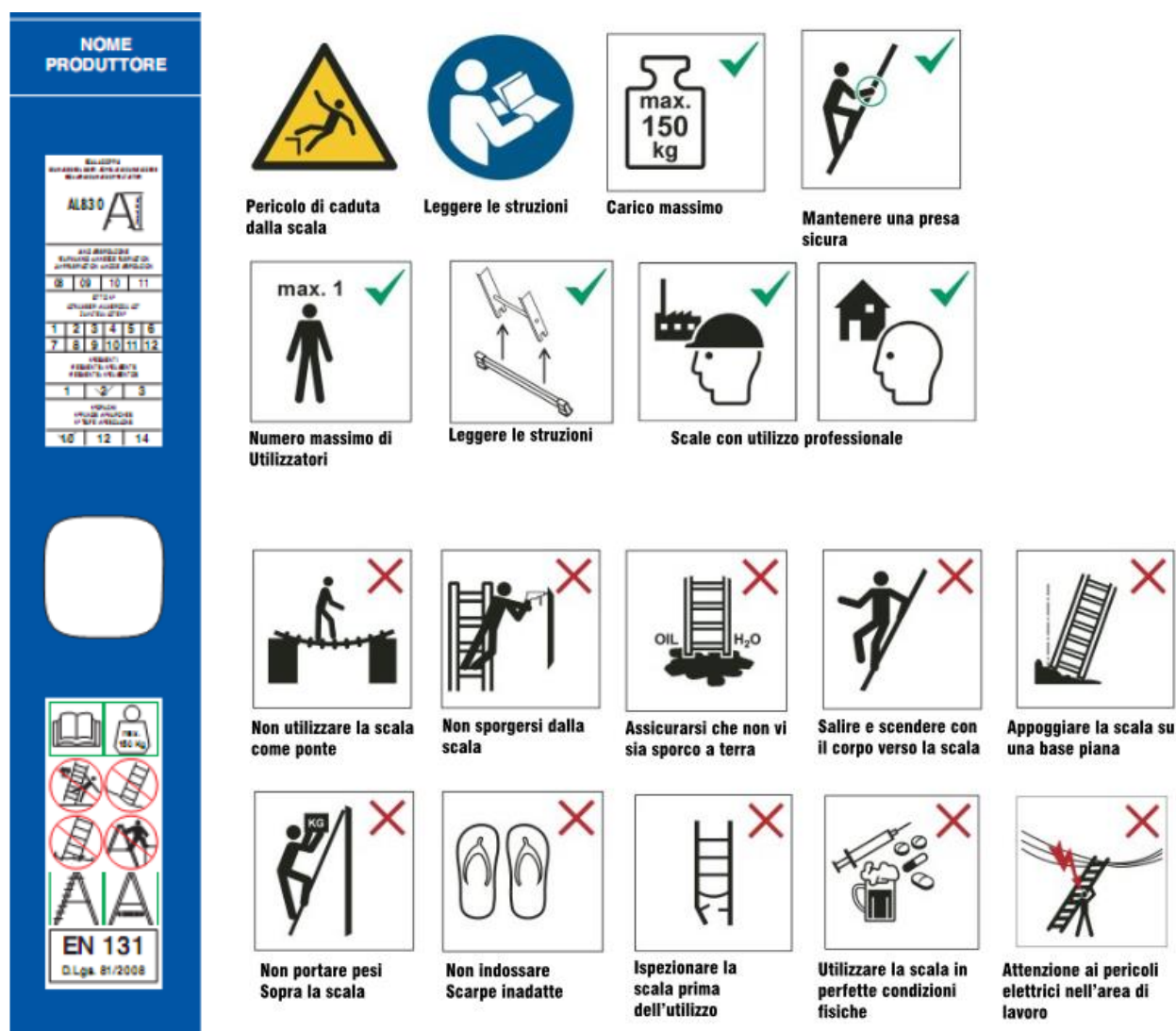
fig. 25 – esempio di marcatura di una scala (a sinistra) e di simboli riportati nella UNI EN 131-3 per la marcatura di sicurezza e per le istruzioni a corredo di tutti i tipi di scale (a destra)
