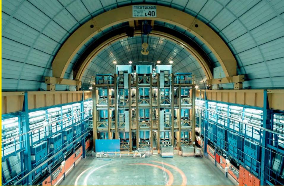
LVD contiene 1000 t di liquido scintillatore, se una Supernova esplodesse nel centro della nostra Galassia (8.5 kpc), sarebbe in grado di rivelare centinaia di neutrini. Il rivelatore è in funzione dal 1992.
